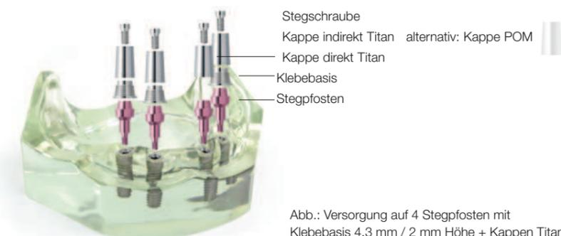
Abb.: Versorgung auf 4 Stegpfosten mit Klebebasis 4,3 mm / 2 mm Höhe + Kappen Titan
